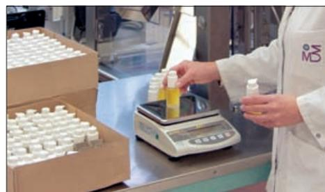
**Pesage avec plage de tolérance (Checkweighing)** : Un signal optique assiste la mise en portions, le dosage ou le triage
